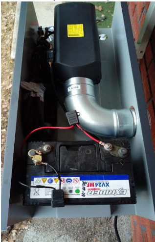
Kuva 5. lämmittimen sijoitus laatikkoon
